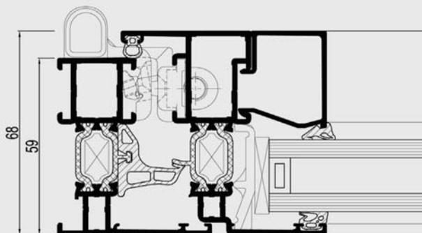
CS 68 is een thermisch geïsoleerd driekamersysteem voor ramen en deuren dat hoge isolatieniveaus combineert met optimale veiligheid.
